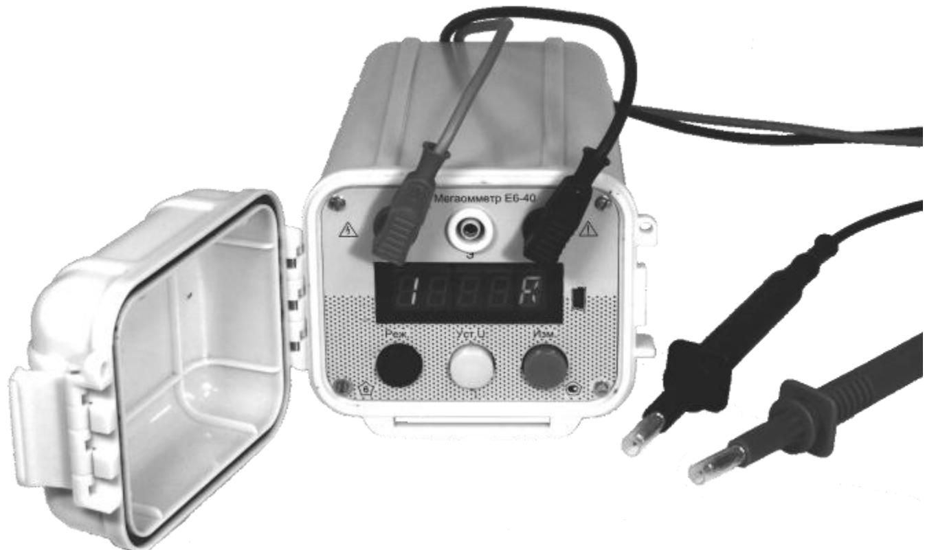
Рисунок 1 - Внешний вид мегаомметра.
